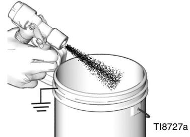
**NOTA:** Si se usa una pistola con asistencia por aire, aumente la presión de aire girando el regulador de la pistola en sentido horario.
